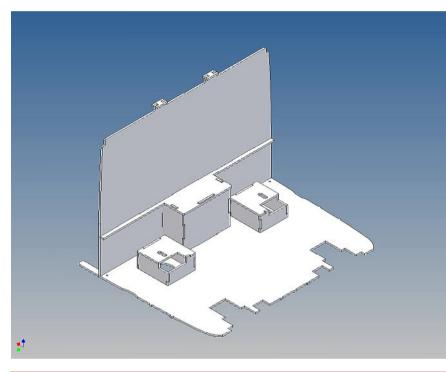
Halteplättchen von unten gegen die originalen Sitzhalter kleben und anschließend mit dem Boden (von unten 2,2x4,5mm Schrauben) verschrauben / Stick the holding plates from the bottom against the original seat holders and then screw them to the floor (from the bottom 2,2x4,5mm Screws)
